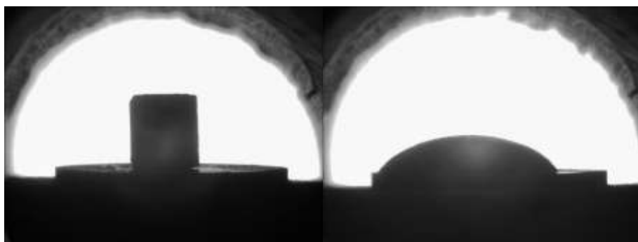
Рис. 3. Фотографии образца стекла состава «г» при температурах 600 и 860 °С
