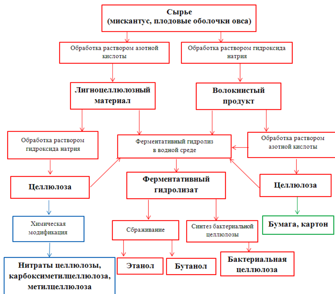
Рис. 1. Комплексная блок-схема переработки недревесного сырья в полезные продукты на опытно-промышленном производстве ИПХЭТ СО РАН
