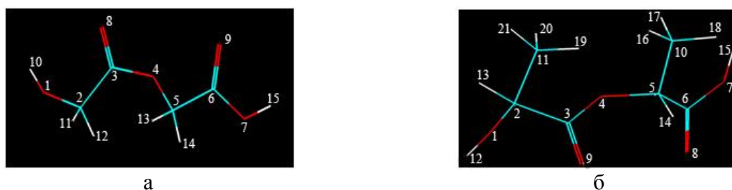
Рис.1. Визуализированные модели димеров молочной (ДМК) (а) и гликолевой (ДГК) (б) кислот
