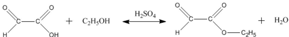
Рис. 1. Схема реакции этерификации ГК этиловым спиртом
